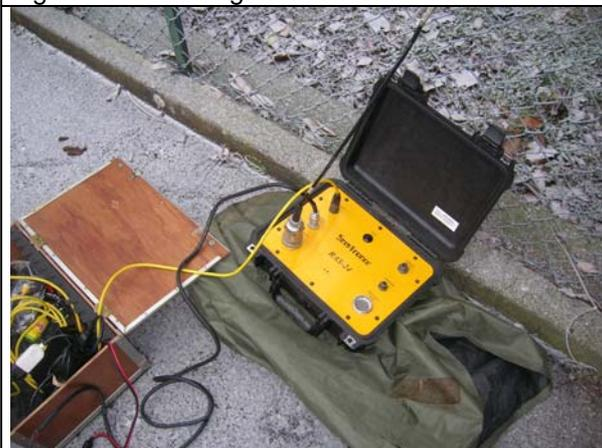
Fig. 9: Centralina acquisizione dati
