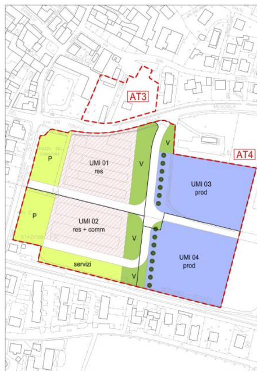
●●●● fascia a filtro verde da realizzare su area privata
