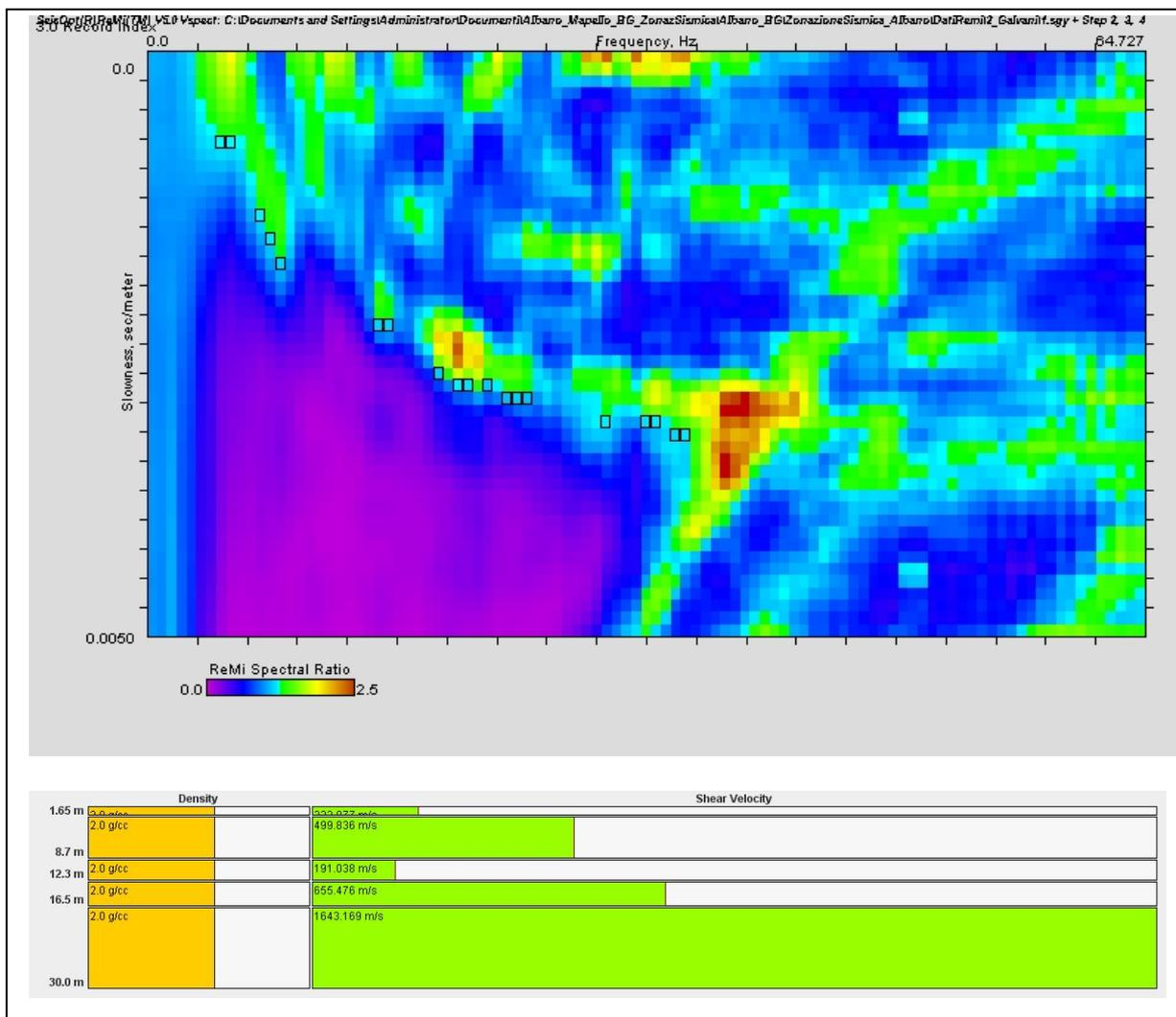
**Figura 4** – REMI 2 - Dispersione della Velocità di fase delle onde di Rayleigh per il sito *ReMi* - RAYLEIGH WAVE PHASE VELOCITY DISPERSION CURVE
