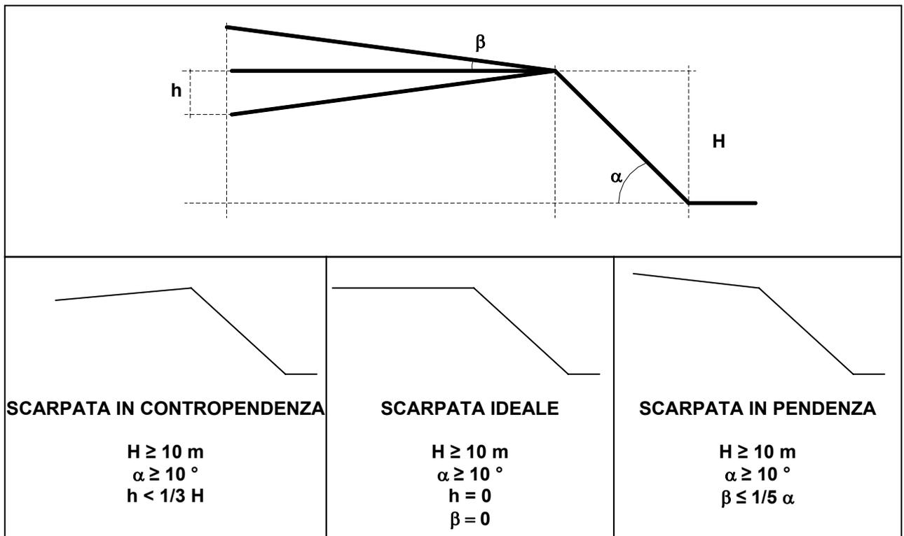
Sulla base delle situazioni reali identificate sono stati costruiti modelli caratterizzati da diverse altezze  $H$ , diverse inclinazioni  $\alpha$  del fronte principale e diversa tipologia del fronte superiore ed è stato calcolato l'andamento del valore del Fattore di amplificazione per l'intervallo di periodo compreso tra 0.1-0.5 s e 0.5-1.5 s lungo il fronte superiore, identificando anche l'area di influenza ( $A_i$ ) dei fenomeni di amplificazione sismica.
