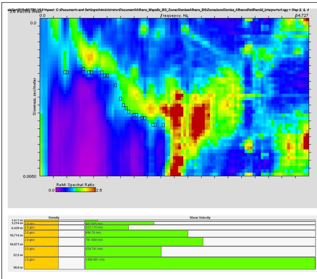
**Figura 5** – REMI 3 - Dispersione della Velocità di fase delle onde di Rayleigh per il sito *ReMi* - RAYLEIGH WAVE PHASE VELOCITY DISPERSION CURVE
