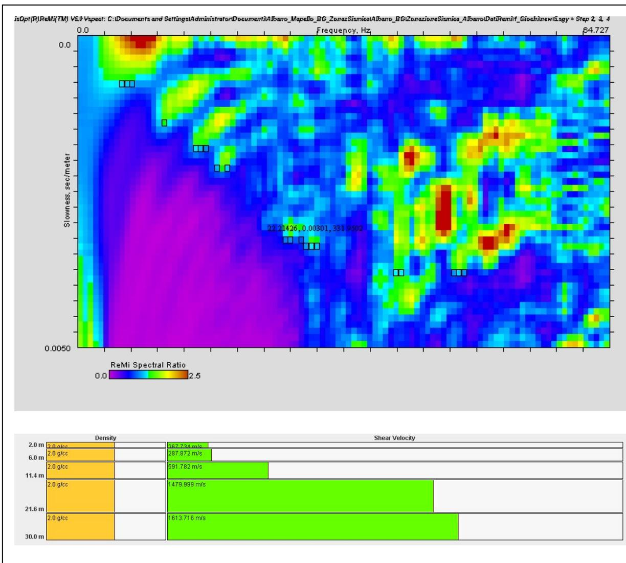
**Figura 3** – REMI 1 - Dispersione della Velocità di fase delle onde di Rayleigh per il sito *ReMi* - RAYLEIGH WAVE PHASE VELOCITY DISPERSION CURVE
