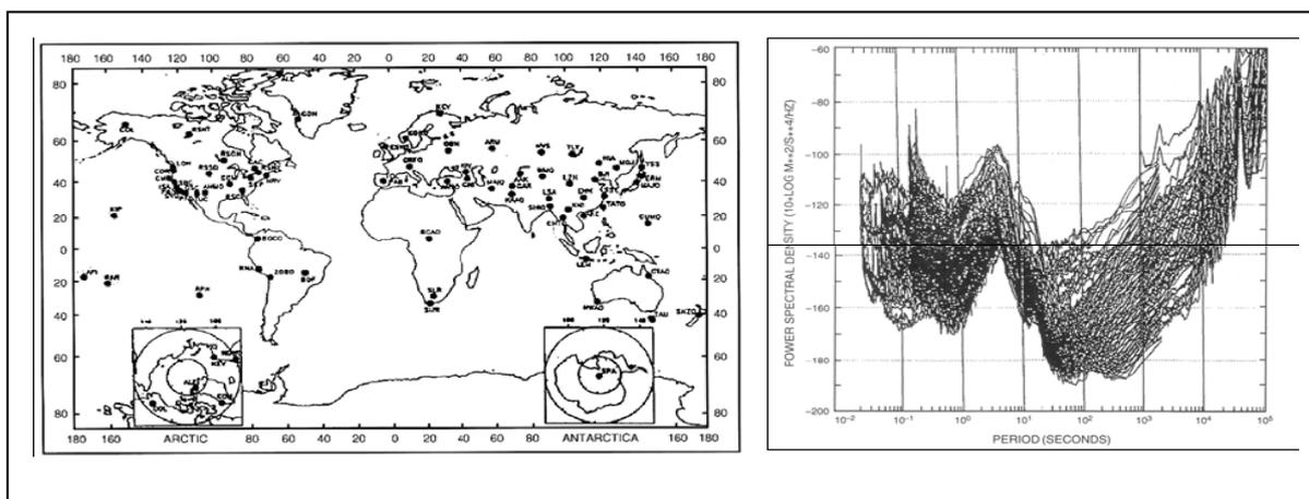
**Figura 1** - Potenze spettrali di accelerazione della componente verticale dei microtremori (a destra) registrate in 75 osservatori sismici distribuiti su tutto il globo terrestre (Peterson, 1993).
