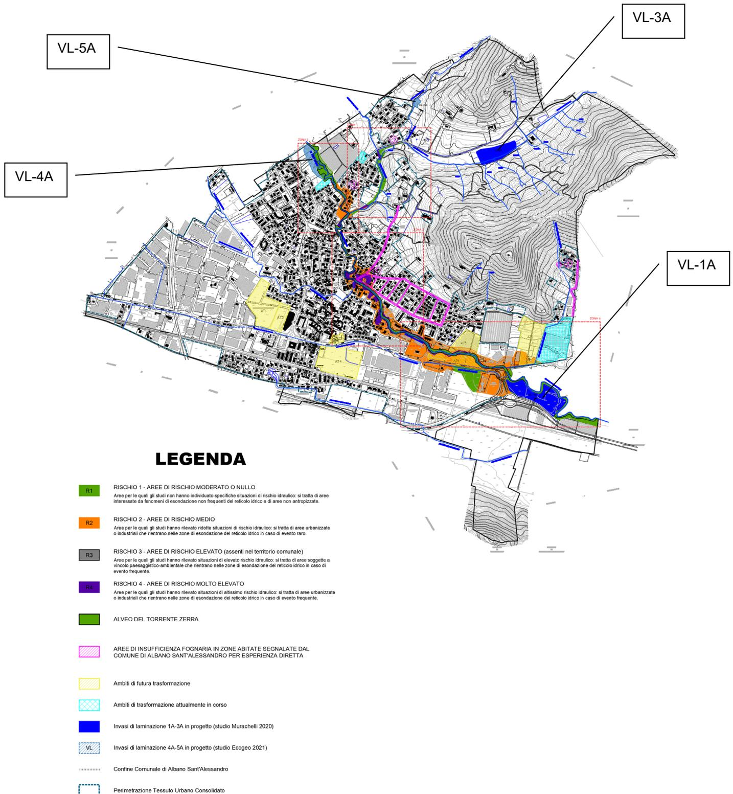
**Figura 9** – Carta del Rischio idraulico CON interventi di laminazione (estratto da REL.RG/17413/21, rif.P10974 a cura del Dott. Diego Marsetti, anno 2021)
