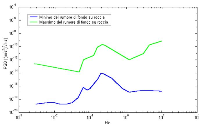
**Figura 2** - Modelli standard del rumore sismico massimo (in verde) e minimo (in blu) per la Terra. Gli spettri di potenza sono espressi in termini di accelerazione e sono relativi alla componente verticale del moto.
