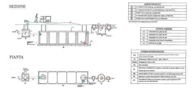
LA CHIUSURA DELLA VASCA E' REALIZZATA CON L'INSTALLAZIONE DI ELETTROVALVOLA REGOLATA NEL FUNZIONAMENTO DA SENSORE DI LIVELLO IN VASCA, TIMER E SENSORE DI PIOGGIA
