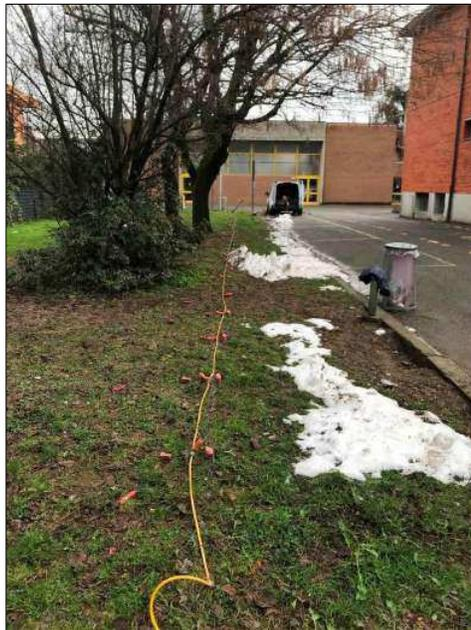
*Stendimento sismico M.A.S.W.*
