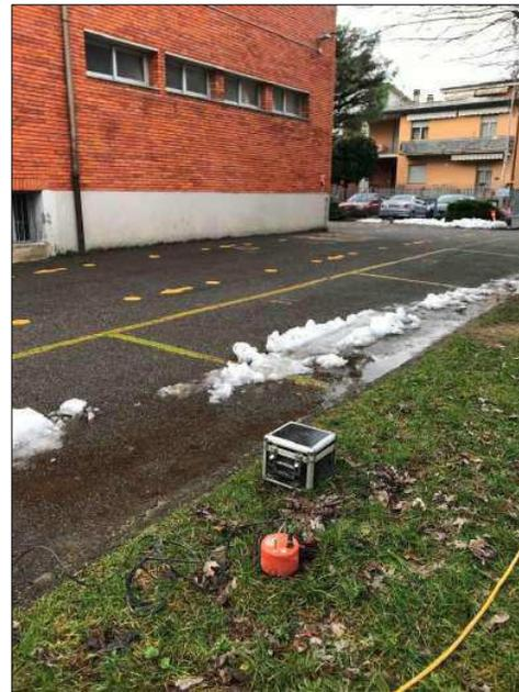
*Misura del microtremore sismico
